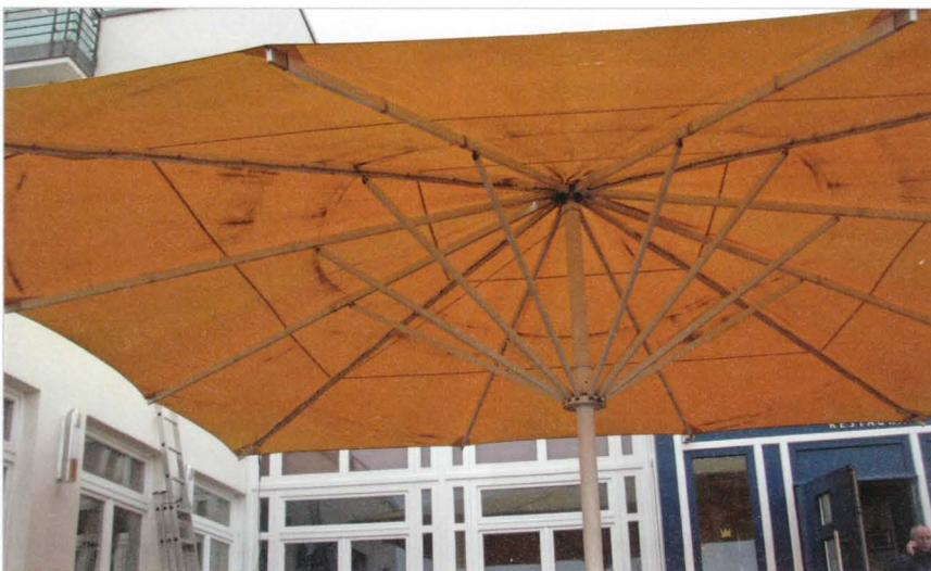
Die hier sichtbaren senkrechten Gewebebrüche (schwarze Streifen), verursacht durch falsches Zusammenlegen und Sichern des Sonnenschirms, gehen laut Sachverständigem Müller bereits nach kurzer Zeit in Löcher über.
